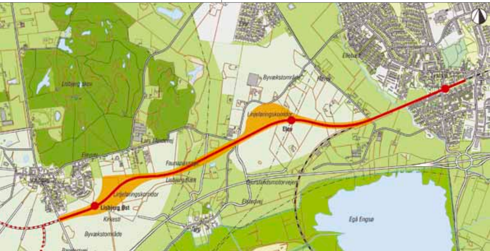
Figur 1-14 Oversigtkort af strækningen fra Lisbjerg til Lystrup. Orange område angiver områder for eventuelle justeringer af linjeføring i forhold til fremtidig byudvikling ved Lisbjerg og Elev.
