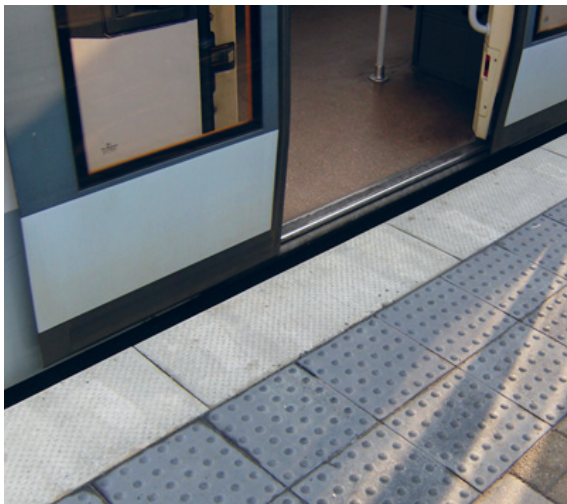
Foto: Tog og perron vil så vidt muligt være i samme niveau på standsningsstederne, og afstanden mellem perron og tog så lille som mulig (Kilde: Letbanesekretariatet)
