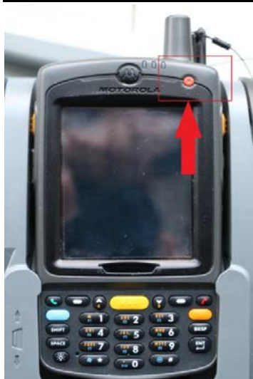
Hold den røde knap nede indtil den hvide startskærm med midtrafiklogo kommer frem. (10 Sek)
